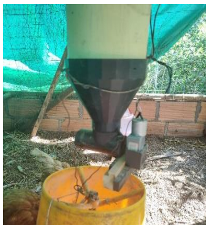
Fig. 1 Prototipo de dispensador automático de alimento para gallinas.
