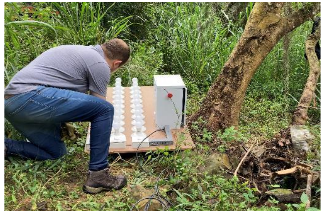
Fig. 10. Banco de bombillas LED para verificar potencia generada por la turbina en ambiente relevante.
