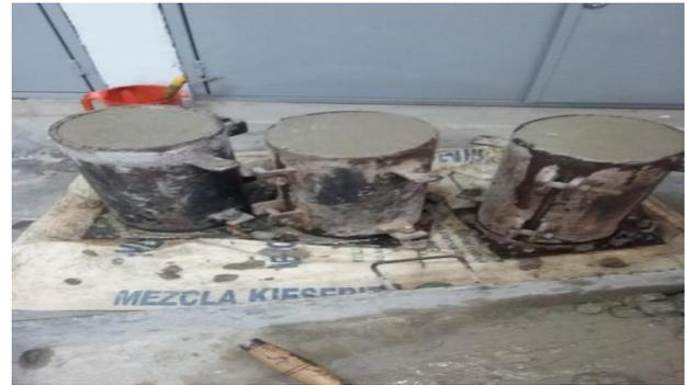
Fig. 3. Fabricación y curado de probetas.
